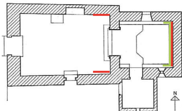
Planta do edifício com localização das pinturas.
